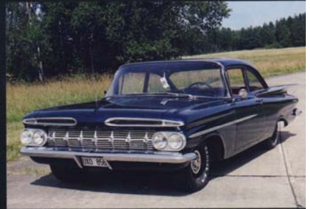
Till årsmodell -59 fick Chevrolet ett helt nytt utseende på fronten då strålkastarna flyttades ner i grillen. Huven blev nu rätt platt med blinkers monterade längst ut på kanterna.
